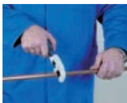
1. Corte de tubo 1. Cortar o tubo
