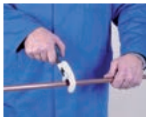
1. Corte de tubo 1. Cortar o tubo
