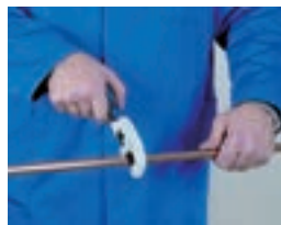
1. Corte de tubo 1. Cortar o tubo
