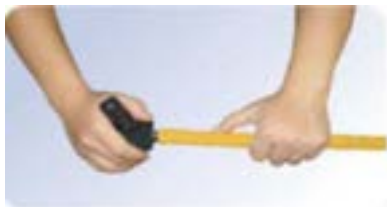
2.- Aborcardar y Redondear 2.- Abocardar e Arredondar
