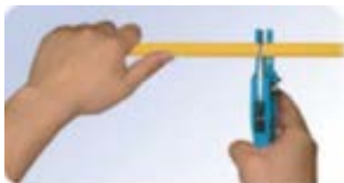
1.- Corte de tubo 1.- Cortar o tubo
