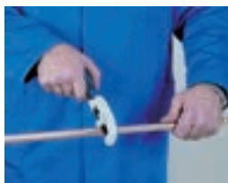
1. Corte de tubo 1. Cortar o tubo
