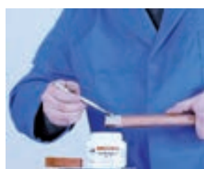
4. Aplicación del decapante 4. Aplicação do decapante
