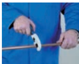
1. Corte de tubo 1. Cortar o tubo
