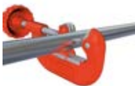
1. Corte de tubo 1. Cortar o tubo
