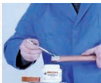
4. Aplicación del decapante 4. Aplicação do decapante
