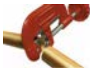
1. Corte de tubo 1. Cortar o tubo
