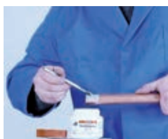
4. Aplicación del decapante 4. Aplicação do decapante
