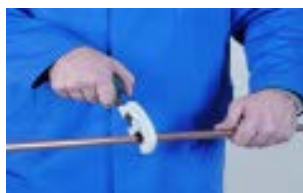
1.- Corte de tubo 1.- Cortar o tubo
