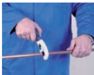
1. Corte de tubo 1. Cortar o tubo
