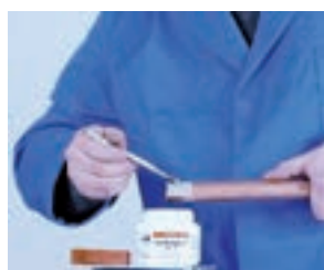
4. Aplicación del decapante 4. Aplicação do decapante
