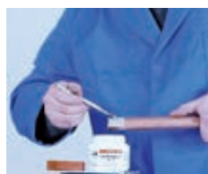
4. Aplicación del decapante 4. Aplicação do decapante
