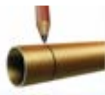
3. Marcar profundidad inserción 3. Marcar profundidade insercion
